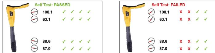
Si el test es negativo vuelva a repetirlo en una zona libre de interferencias. Si el test sigue siendo negativo retorne el equipo a Vivax-Metrotech o a su distribuidor autorizado.
