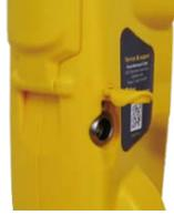
Conecte el conector del cargador al receptor. Conecte el cargador a la red y enciéndalo. El LED indicador de carga estará en rojo hasta llegar a la plena carga momento en el que se pondrá en verde.
